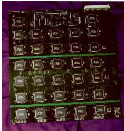
Abbildung 3.7: Mainboard der DES-Cracking Machine der Electronic Frontier Foundation (EFF) (siehe [255]).
