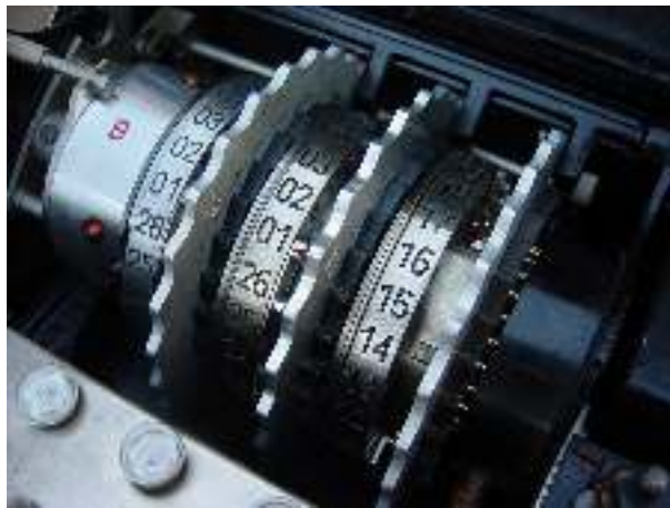
Abbildung 2.8: Details der Enigma, die Rotoren.
